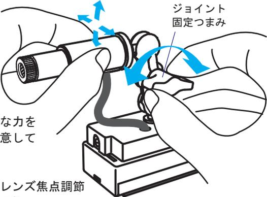
5. ラインの焦点をレンズ焦点調節リングを回して調整してください。この時ラインの向きも回転します。レンズ焦点調節リングは回し過ぎると外れて中のスプリングが飛び出しますのでご注意ください。
