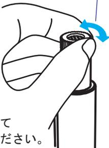
6. ラインの向きを変える場合は、ジョイント固定つまみを回して緩めて、レーザーカバーごとボールジョイントから回して調節してください。この時、大きく回してケーブルに無理な力をかけないでください。
